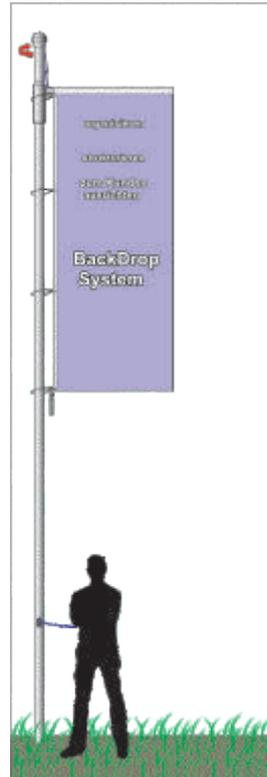
**Achtung!** Den Hissvorgang vor dem letzten Meter unterhalb des Mastkopfes verlangsamen, damit sich der Mastkopf zum Hisschlitten / Ausleger ausrichtet,
